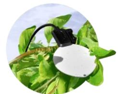
**Sencrop Plus** comprend 2 stations météo connectées : la Raincrop qui mesure la pluviométrie, et prend une mesure triple de la température et de l'humidité de l'air, et la Windcrop, mesurant la vitesse du vent et sa direction, bien comme les rafales. Ce couple de stations permet aux agriculteurs de **programmer leurs traitements au plus près des conditions météorologiques de leur parcelle**, en se conformant à la
