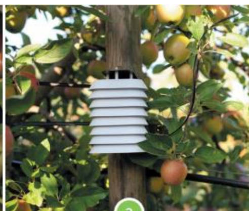
3 Abri avec capteurs de température et d'hygrométrie
